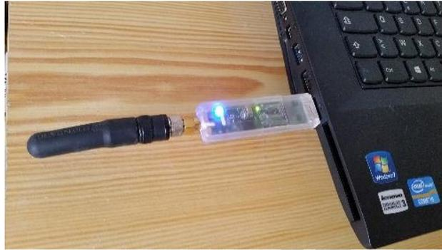
El DVmini se conecta como un pendrive, mediante USB y requiere de un PC con conexión a internet para funcionar y dar operatividad a los equipos que se conecten con él a través de su transmisor UHF.
