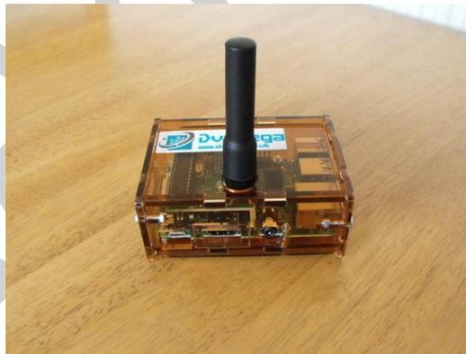
El funcionamiento de ambos es similar al de un router wifi, dando cobertura de red (en este caso red DMR) en la banda de VHF o UHF para una pequeña zona donde vamos a utilizar la radio, por ejemplo nuestro QTH. Su potencia es de solo 12 mw.
